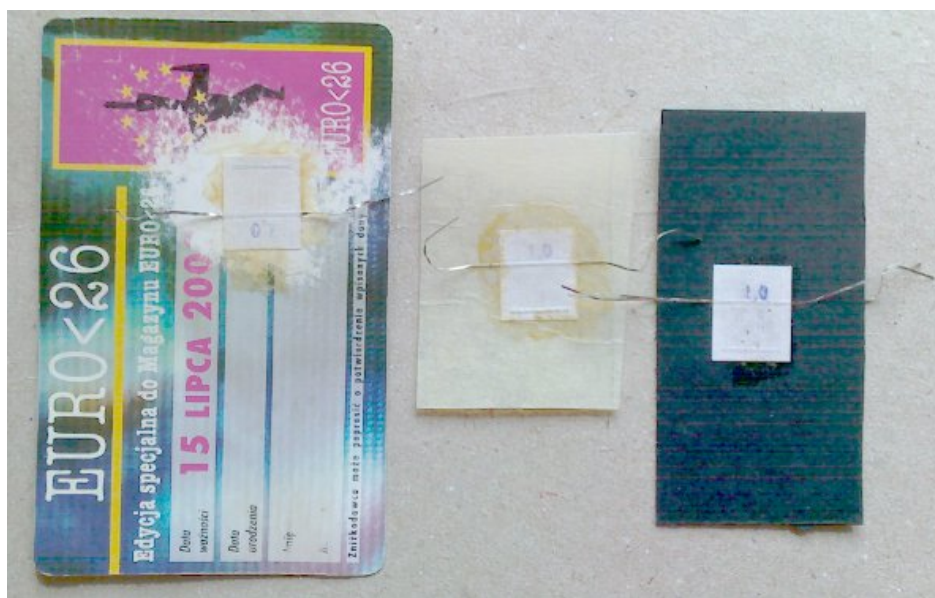
Rysunek 4.12: Tensometry przyklejone do różnych powierzchni
